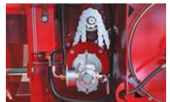
Der Pumpenantrieb erfolgt über einen Zahnradmultiplikator. Hinter der Pumpe ist ein Druckfilter angebracht, der für zusätzliche Sauberkeit des Öls im System sorgt.
