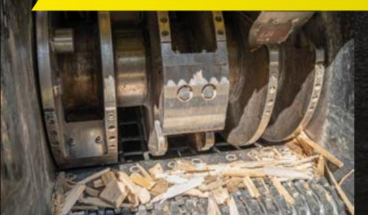
Der Holzhacker ist vollständig aus Hardox gefertigt. Mit einem extrem robusten Rotor und breiten Messern sorgt er für einen sauberen Schnitt und weniger Staubpartikel, selbst bei der Verarbeitung von feinem Material und Schnittresten. Die kompakte Bauweise ohne überflüssige Abdeckungen ermöglicht einfache Wartung und langanhaltende Zuverlässigkeit.
