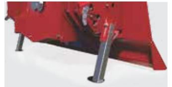
Zwei klappbare Abstellfüße sorgen für die nötige Stabilität der frei stehenden Seilwinde (Abstellfüße sind nicht klappbar bei EGV 35 A und DGV 2X55 AHK)
