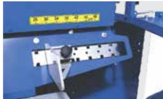
Der hydraulische Längenbegrenzer ist verstellbar. Bei jedem Vorschub des Holzstammes stoppt ihn der Begrenzer auf der eingestellten Länge. Zu Beginn des Sägens rückt er zurück, was einen widerstandslosen Schnitt des Holzstammes ermöglicht.
