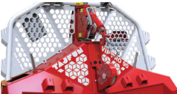
Zusätzlich zum Endabschalter verfügt die obere Umlenkrolle über einen integrierten Drahtseilvorschubeinschaltmechanismus mit einem Stellknopf. Der Mechanismus ist durch ein Umlenkrollengehäuse und Abdeckungen vor mechanischer Beschädigung geschützt.
