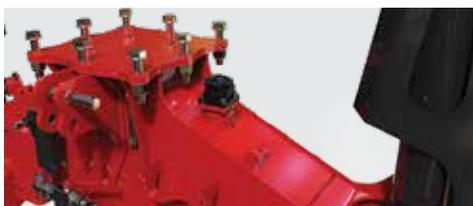
Druck- und Rücklauffilter zur Gewährleistung der entsprechenden Öleinheit im Hydrauliksystem.
