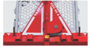
Schlitze zum Einhängen der Kette und zusätzliche Einhängemöglichkeiten
