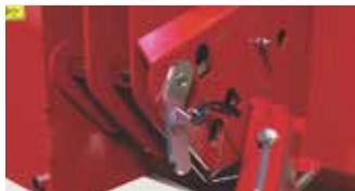
Anschluss mit patentiertem Sicherungssystem.\* Zwei Löcher für den Anschluss ermöglichen eine optimale Annäherung der Winde zum Traktor für eine größere Stabilität (nicht anwendbar für EGV 35 A, EGV 105 AHK und DGV 2X55 AHK)
