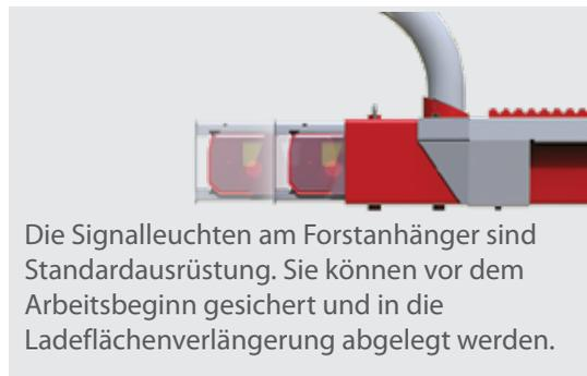
Die Signalleuchten am Forstanhänger sind Standardausrüstung. Sie können vor dem Arbeitsbeginn gesichert und in die Ladeflächenverlängerung abgelegt werden.
