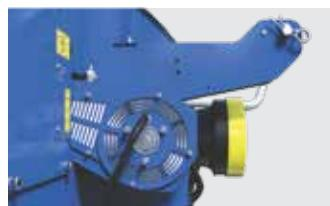
Elektrohydraulisch gesteuerte Kupplung schaltet die Sägekette automatisch zu und ab. Grundausführung bei RCA 400 JOY, RCA 480 JOY.
