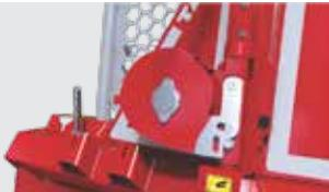
Verbesserte untere Umlenkrolle mit patentiertem System für ein schnelles Einhängen und Aushängen des Seils
