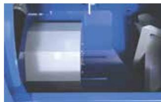
Spaltzylinder - zwei Spaltgeschwindigkeiten sind vorhanden: schnelles Spalten bei weicherem Holz, langsames Spalten bei härterem Holz. Die Geschwindigkeit schaltet hinsichtlich der Holzstärke automatisch um (RCA 380 (E), RCA 400 JOY, RCA 480 JOY, RCA PRO 500).
