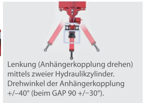
Lenkung (Anhängerkopplung drehen) mittels zweier Hydraulikzylinder. Drehwinkel der Anhängerkopplung +/-40° (beim GAP 90 +/-30°).
