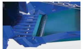
Zwischen dem Spaltmesser und dem Förderband befindet sich ein Gitter, durch welches die Sägespäne und kleinere Splitter fallen.
