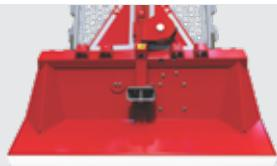
Anhängekupplung (Zugöse) - Grundausüstung eingebaut, mit den Bolzen abnehmbar (nicht anwendbar für VIP PRO 90 und DGV 2X55 AHK)
