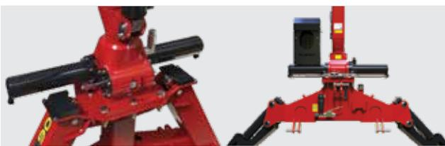
Robustes Schwenksystem mit Robustes Drehsystem mit Zahnstange und zwei Zylindern (DOT 40K) bzw. zwei Zahnleisten und vier Schwenkzylindern. (DOT 50K, DOT 55K 85, DOT 50ZK).
