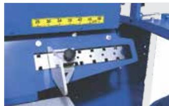
Hydraulischer Längenbegrenzer ist verstellbar. Bei jedem Vorschub des Holzstammes stoppt ihn der Begrenzer auf der eingestellten Länge. Zu Beginn des Sägens rückt er zurück, was laufendes Sägen des Holzstammes ermöglicht.
