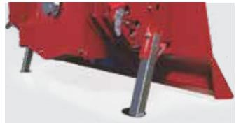
Zwei klappbare Abstellfüße sorgen für die nötige Stabilität der frei stehenden Seilwinde (Abstellfüße sind nicht klappbar bei EGV 35 A und DGV 2X55 AHK)
