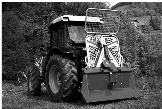
Компактная конструкция лебедок с большой производительностью; 30–50 м³ леса на смену
