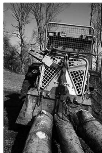
Компактная конструкция лебедок с большой производительностью; 30–50 м³ леса на смену
